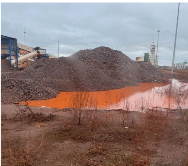
Железная руда на открытом складе. Лужи ярко-оранжевого цвета, земля и стены зданий в красно-буром налёте – всему виной красящий пигмент оксида железа – гематита
